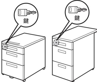
鍵を左に180度回転すると、3段の引出しすべてが施錠されます(オールロック機構)。右に180度回転すると開錠されます。
