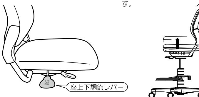
レバーを引きながら座面に体重をかけると座面が下がります。体重をかけない状態でレバーを引くと座面が上がりります。
